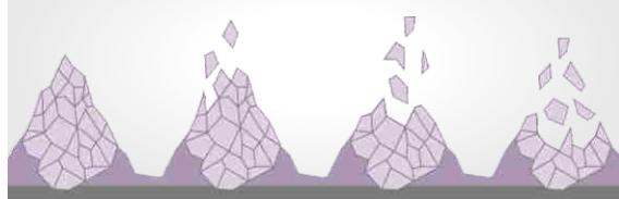
Keramičko zrno koje se koristi ima oštре vrhove, koji se postepeno troše tokom brušenja, pružajući, na taj način, dug vek trajanja i bolje finiširanje.
