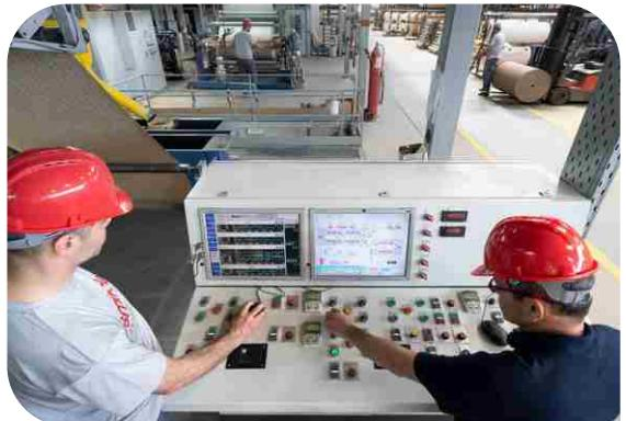
Danas, tako, dve automatizovane proizvodne linije mogu proizvesti 40.000m<sup>2</sup> u smeni. Obe su opremljene mašinama za elektronsku kontrolu, što osigurava stabilan kvalitet proizvoda, stalnom proverom i merenjem po kriterijumima prihvatljivosti. Time se eliminiše mogućnost odstupanja od proizvodnih standarda postavljenih za svaki proizvod.
