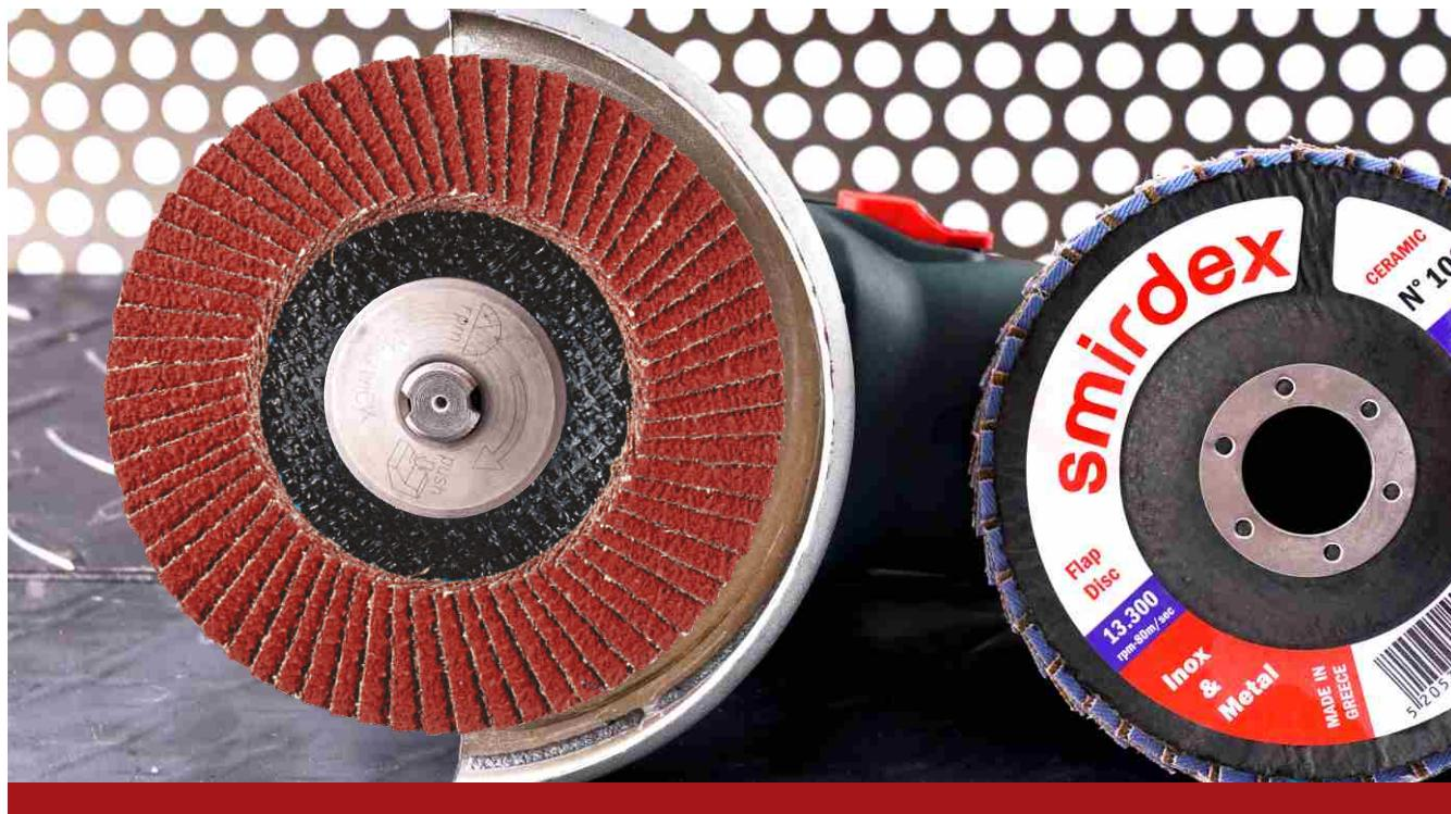
Flap diskovi 919 su dugotrajni i pogodni za brušenje metala. Napravljeni od 100% keramičkih zrnaca i nalepljeni hladnim premazom, pogodni su za poslove na tvrdim metalima kao što je čelik, dakle svuda gde su visoki i pritisak i temperatura.
