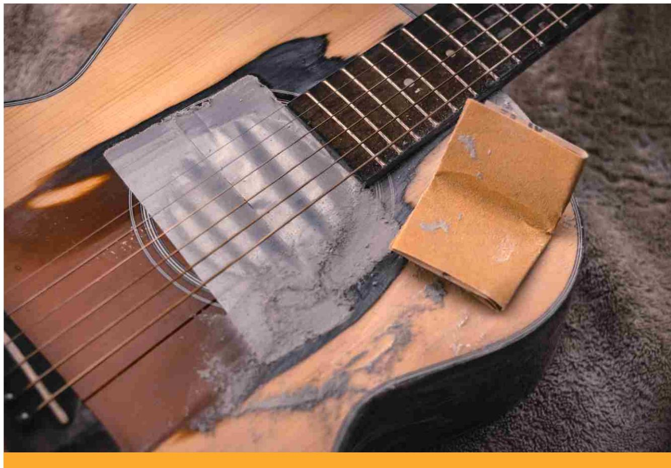
Serija 135 je idealno rešenje za brušenje teških automobilskih i drvenih površina. Posebno obradjena zrnca aluminij-oksida čine seriju 135 idealnom za brušenje površina prekrivenih gitovima, osnovnim premazom, lakom, drvetom. Uz to, poseban premaz stearata pomaže da se uspori zapušavanje kao i da se produži vek trajanja brusnog papira.
