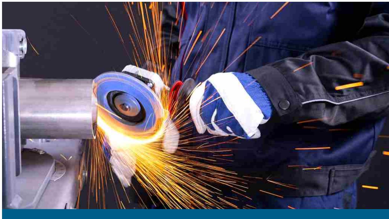
Flap diskovi 915 se koriste za brušenje metala i inoxa. Mali komadi, od platna visokog kvaliteta sa 100% cirkonijuma, su nalepljeni na osnovu od fibera, stvarajući jedan otporan proizvod izuzetnog učinka i velike brzine brušenja.
